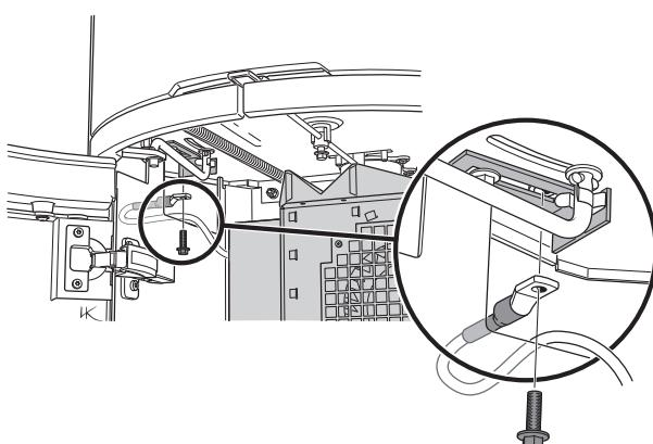
**! Il sensore di temperatura può essere fissato solamente con un capocorda. Eventuale danno alla guaina del cavo comporta il rischio di morte.**
