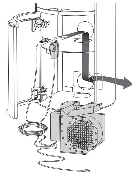
Den Schaltkasten und den Stecker durch die beiden hinteren Bleche führen.
