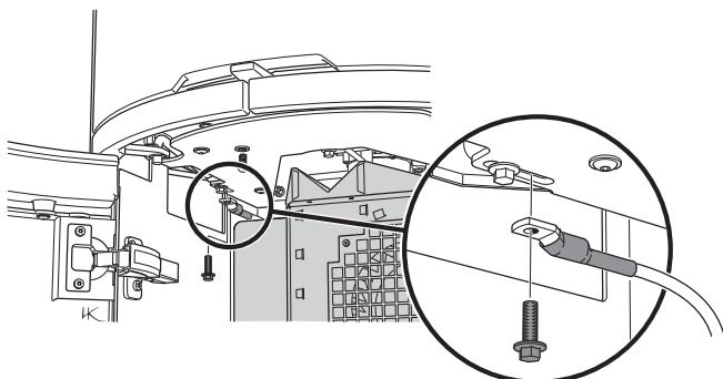
Entfernen Sie die innere Schraube des Rüttelrostbeschlages und befestigen Sie den Temperaturfühler in der entsprechenden Öffnung mit der beigefügten M6X20 Schraube.
