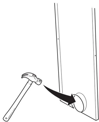
**!** Per montare il cassetto, rimuovere sempre il tappo dalla piastra posteriore per garantire l'alimentazione dell'aria di convezione.
