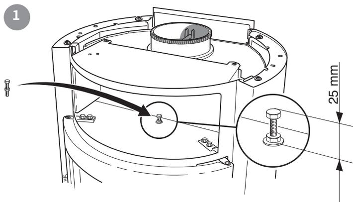
Sostituire le viti di regolazione premontate nella mensola scaldavivande con le viti di regolazione più lunghe in dotazione. Montare la mensola scaldavivande nell'apposito vano e metterla in bolla agendo sulle viti di regolazione. Sul lato della vano per la mensola si trova una piccola scanalatura, da usare per montare la piastra posteriore.
