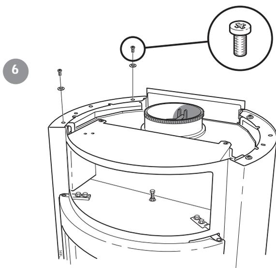
Fissare i fianchi con la vite a stella e la rondella. Regolare i fianchi in modo che tocchino il bordo anteriore dell'insero e la piastra del retro.
