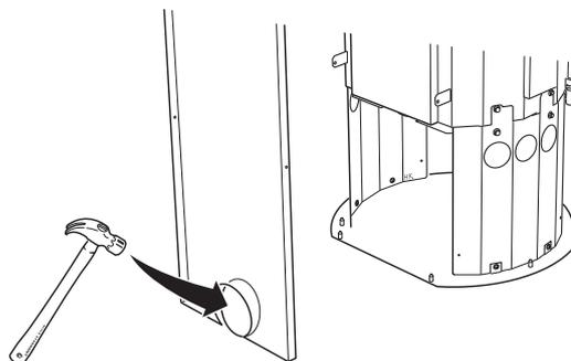
Sul retro e sulla piastra di appoggio della stufa sono presenti dei tappi da rimuovere per il passaggio dei tubi oppure per l'alimentazione dell'aria di combustione, nel caso in cui si desideri montare un cassetto portaoggetto, uno sportello inferiore e/o una ventola (accessori).
