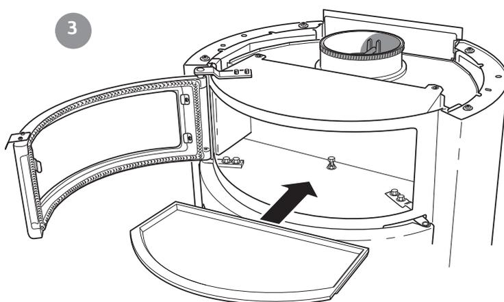
Inserire quindi la piastra posteriore del forno. Regolare eventualmente l'altezza della piastra posteriore agendo sulla vite di regolazione presente sul fondo del forno.
