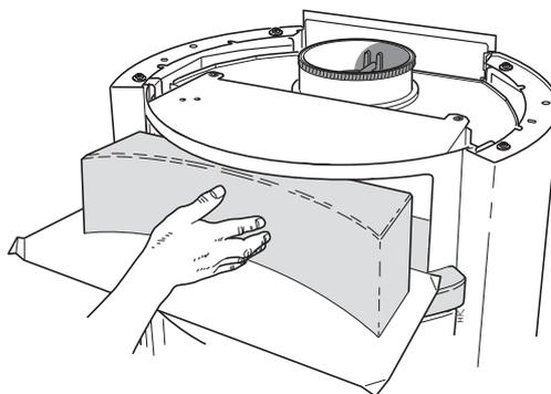
Inserire il fondo della mensola scaldavivande nell'apposito vano e metterlo in bolla agendo sulle viti di regolazione. Proteggere quindi la mensola con la carta dell'imballaggio per evitare di rigarla quando si deve inserire la parte superiore.
