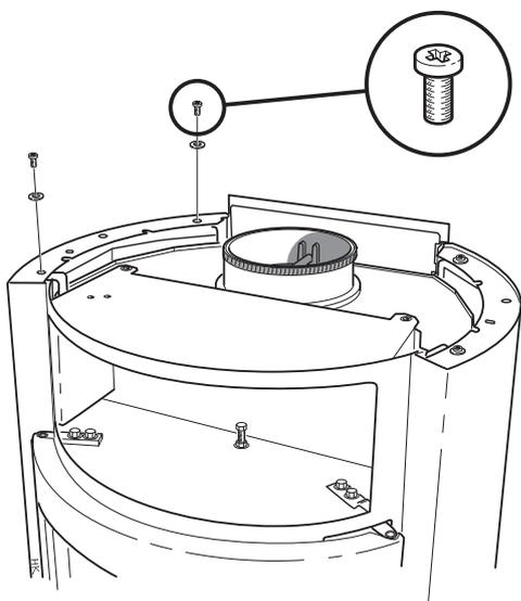
Fissare i fianchi con la vite a stella e la rondella. Regolare i fianchi in modo che tocchino il bordo anteriore dell'inserto e la piastra del retro.
