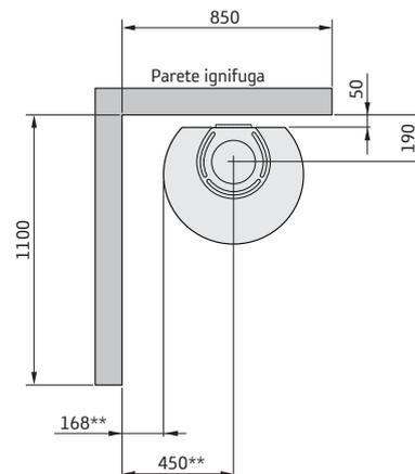
\* Se la stufa è collocata su una piastra di protezione per il pavimento ad esempio in vetro (optional), la distanza dal pavimento va modificata del corrispondente spessore della piastra di protezione, nel caso del vetro di 10 mm.
