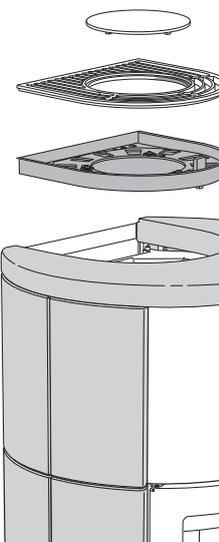
Montare quindi il piano della stufa, la ventola e per ultima la griglia per l'aria calda.
