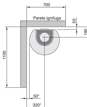
\* Se la stufa è collocata ad esempio su una piastra di protezione per il pavimento in vetro (accessorio), la distanza dal pavimento va modificata del corrispondente spessore della piastra di protezione. Si riferisce anche alle piastre di protezione staccate in vetro (accessorio).
