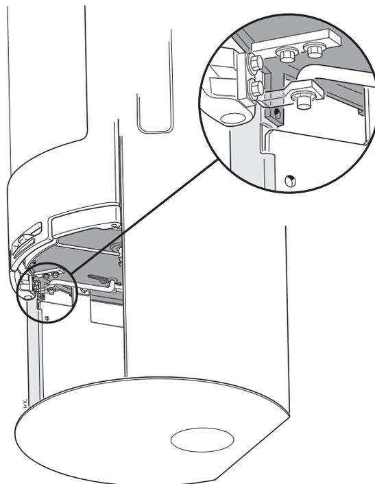
Tenere i fianchi a circa 20 mm sopra la piastra inferiore, ruotare e inserire il bordo anteriore del fianco sul bordo del basamento. Premere e inserire la flangia dei fianchi sui perni del basamento. Avvitare quindi i fianchi al bordo anteriore usando una chiave a brugola.
