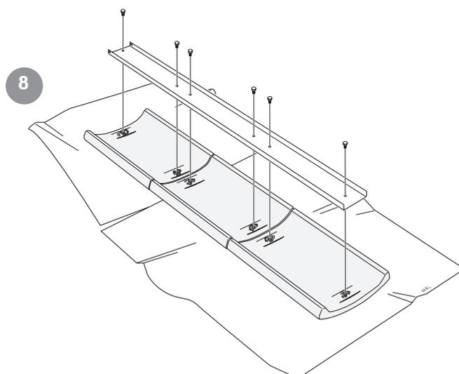
Montare il profilo in acciaio in posizione e avvitarlo senza serrare. Misurare e allontanare se necessario le piastrelle in ceramica, in modo che il fianco misuri in totale 968 mm di lunghezza. Serrare le viti del profilo in acciaio.
