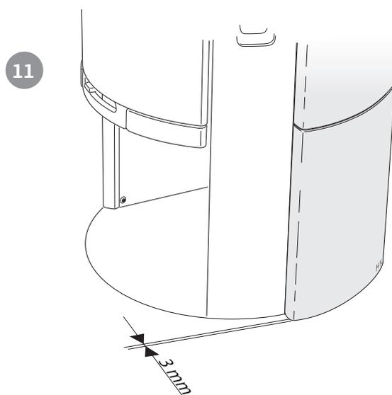
I fianchi in ceramica devono sporgere di 3 mm dal profilo esterno del basamento della stufa. Controllare che i fianchi in ceramica siano bene allineati sia dietro che davanti.
