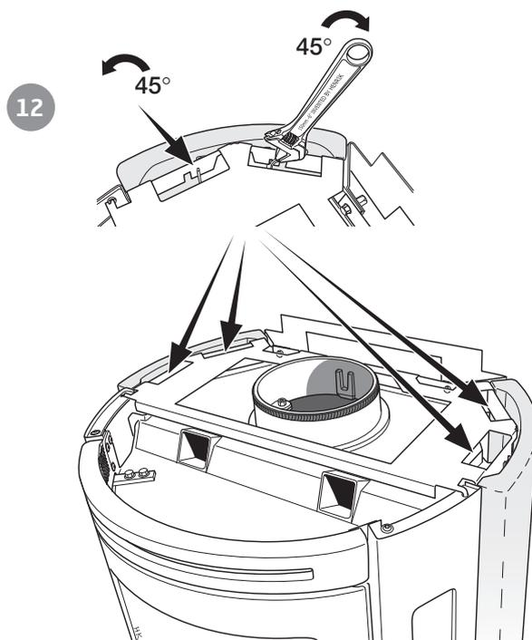
Agganciare il telaio superiore piegando le alette in acciaio.
