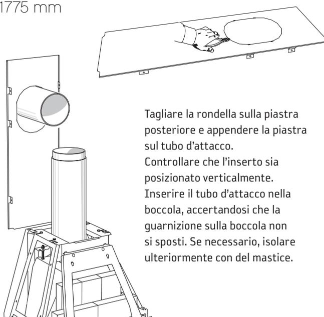
Tagliare la rondella sulla piastra posteriore e appendere la piastra sul tubo d'attacco. Controllare che l'inserto sia posizionato verticalmente. Inserire il tubo d'attacco nella boccola, accertandosi che la guarnizione sulla boccola non si sposti. Se necessario, isolare ulteriormente con del mastice.
