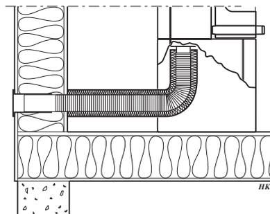
Nel collegamento di questo tipo rimuovere prima la protezione di controllo che si trova davanti alla presa d'aria del pannello posteriore.
