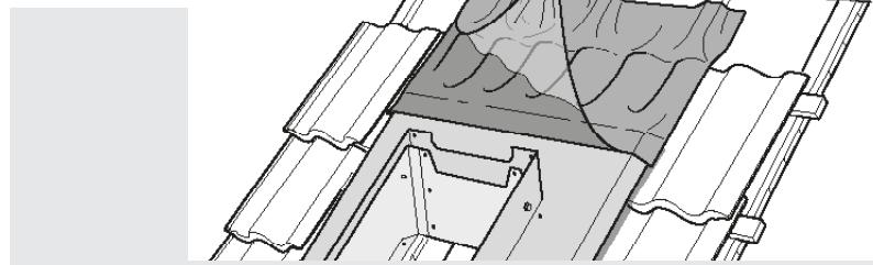
**NO** Fjern såpass mye av beskyttelsespapiret at gummiduken kan festes langs kantene. Trykk fast gummiduken og form den etter pannprofilen i området der takpannene overlapper hverandre. Sørg for at gummiduken formas mykt uten skarpe folder og kraftig strekking.
