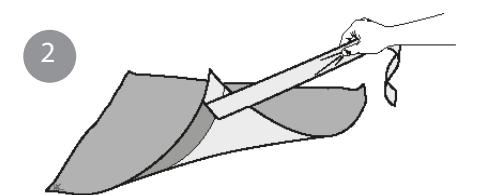
**SE** Avlägsna en remsa av det perforerade skydds-papperet och fäst gummiduken ca 50 mm in på överbeslaget.
