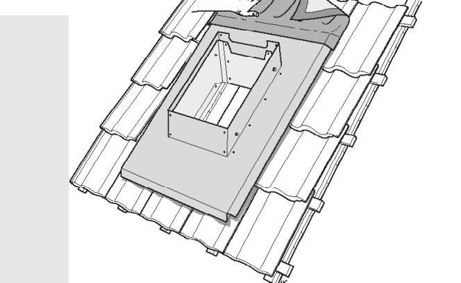
**SE** Avlägsna så pass mycket av skyddspapperet att gummiduken kan fästas längs kanterna. Tryck fast gummiduken och forma den efter pannprofilen i området där takpannorna överlappar varandra. Säkerställ att gummiduken formas mjukt utan skarpa veck och kraftig töjning.
