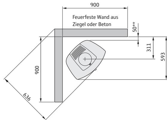
Für brennbare Baubestandteile zugelassener Bereich
