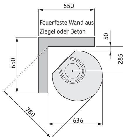
\* Wenn der Kaminofen auf einem Brandschutzbereich z.B. aus Glas (Zubehör) aufgestellt wird, ändert sich die Höhe vom Boden um die Stärke des Brandschutzbereichs. Ein freiliegender Brandschutzbereich aus Glas macht 10 mm aus.
