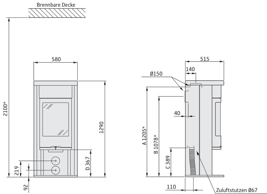
Für brennbare Baubestandteile zugelassener Bereich
