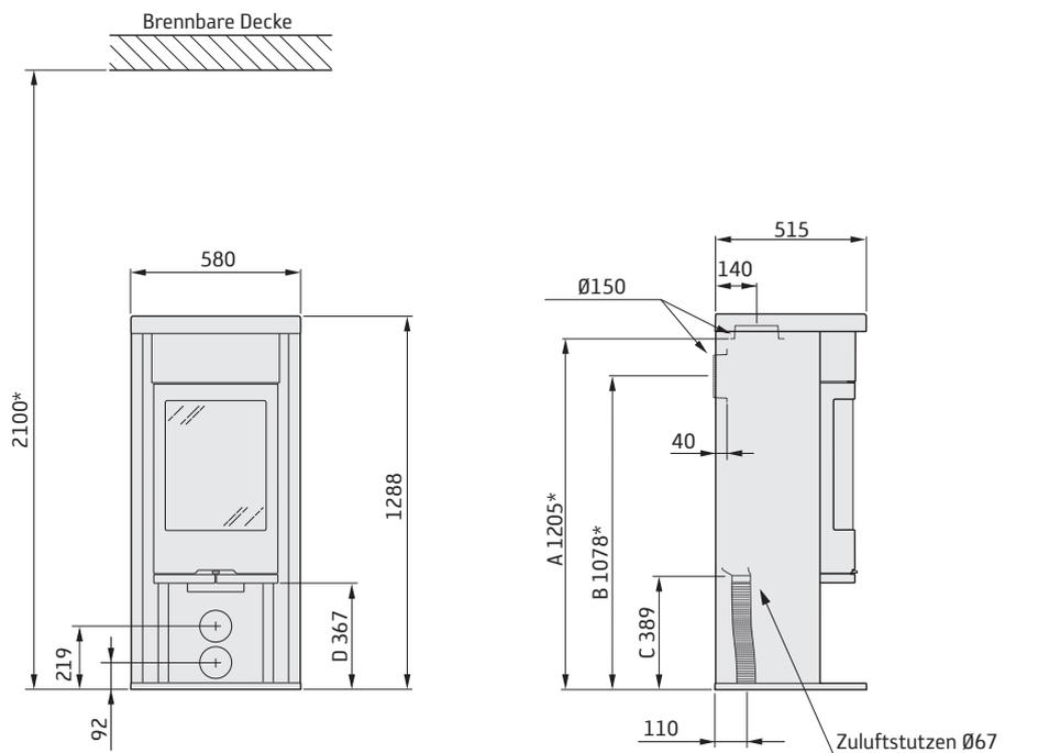
Für brennbare Baubestandteile zugelassener Bereich
