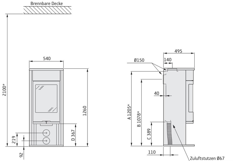
Für brennbare Baubestandteile zugelassener Bereich
