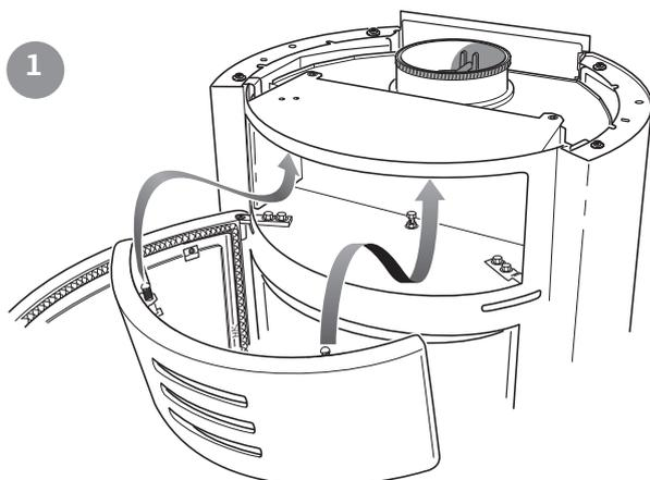
Öffnen Sie die Klappe und montieren Sie die Konvektionsfront mit den Aufhängungsbefestigungen gemäß der Abbildung.
