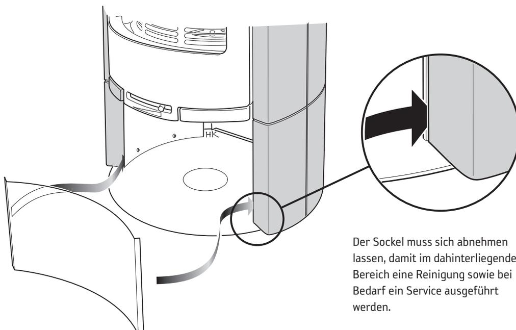
Der Sockel muss sich abnehmen lassen, damit im dahinterliegenden Bereich eine Reinigung sowie bei Bedarf ein Service ausgeführt werden.
