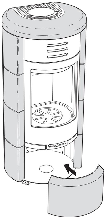
Der Sockel muss sich abnehmen lassen, damit im dahinterliegenden Bereich eine Reinigung sowie bei Bedarf ein Service ausgeführt werden.
