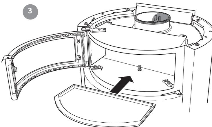
Führen Sie danach das Backblech in den Ofen ein. Justieren Sie evtl. die Backblechhöhe mithilfe der Stellschrauben, die sich am Backfachboden befinden.
