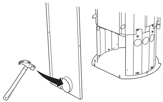
In Rückenblech und Bodenplatte befinden sich Sollbruchstellen, die zwecks Rohrdurchführung oder für eine Luftzufuhr geöffnet werden, wenn der Kaminofen mit einer unteren Tür und bzw. oder einem Ventilator (Zubehör) ausgerüstet ist.
