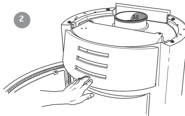
Führen Sie zunächst die Konvektionsfront nach oben, sodass sich die federnde Verriegelung innerhalb der Frontverkleidung des Kaminofens befindet und drücken Sie die Konvektionsfront leicht nach oben. Drücken Sie die Vorderseite hinein, sodass sie sich an die richtige Stelle schiebt.
