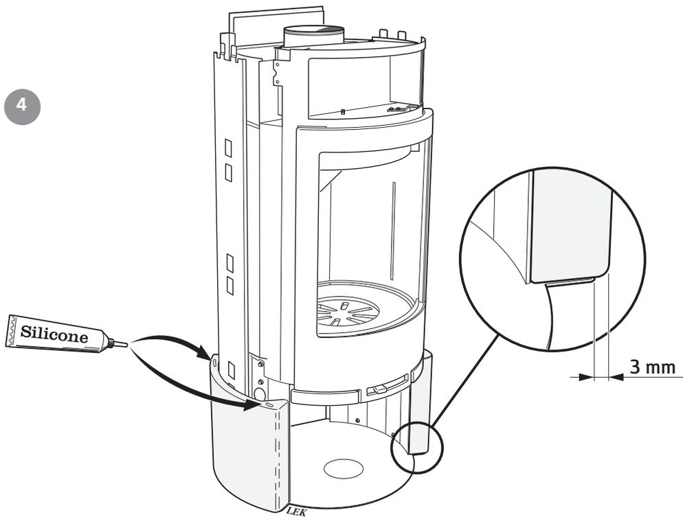
! Behandeln Sie die Kacheln vorsichtig. Besonders an scharfen Kanten besteht Beschädigungsgefahr durch Stoßeinwirkung.
