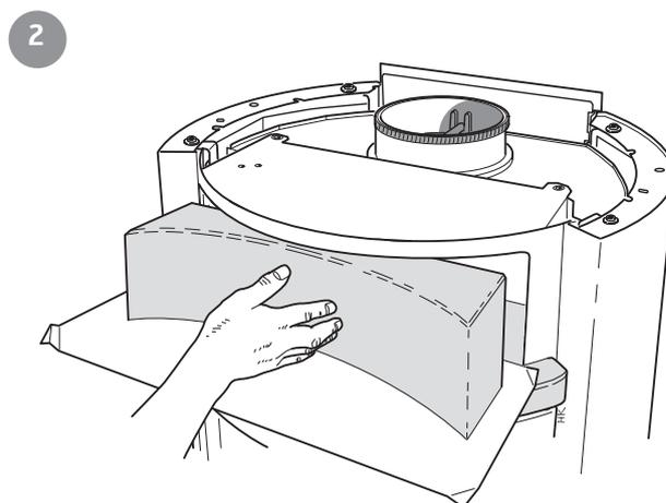
Die Bodenplatte der Warmhaltenische wird im Warmhaltefach montiert. Verwenden Sie an der Rückseite Stellschrauben für eine waagerechte Montage. Legen Sie danach Verpackungspapier zum Schutz vor Kratzern aus, wenn die Oberseite in die richtige Position geschoben wird.
