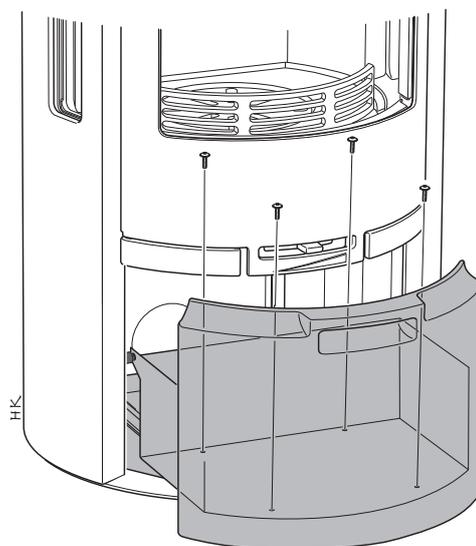
Montieren Sie das Auszugsfach mit vier Inbusschrauben an der Auszugseinheit. Justieren Sie das Fach, sodass es genau mittig ist und ziehen Sie dann die Schrauben an.
