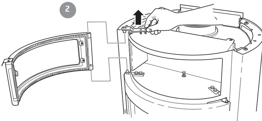
Positionieren Sie die Backfachklappe auf dem Zapfen. Haken sie das obere Scharnier fest und ziehen Sie eine der Schrauben leicht an. Schließen Sie die Backfachklappe und stellen Sie diese waagrecht ein. Öffnen Sie sie im Anschluss daran vorsichtig und ziehen Sie beide Schrauben fest an.
