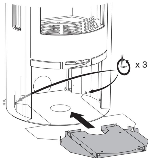
Lösen Sie die hintere Inbusschraube drei Umdrehungen. Legen Sie die Auszugseinheit auf das Fußblech.
