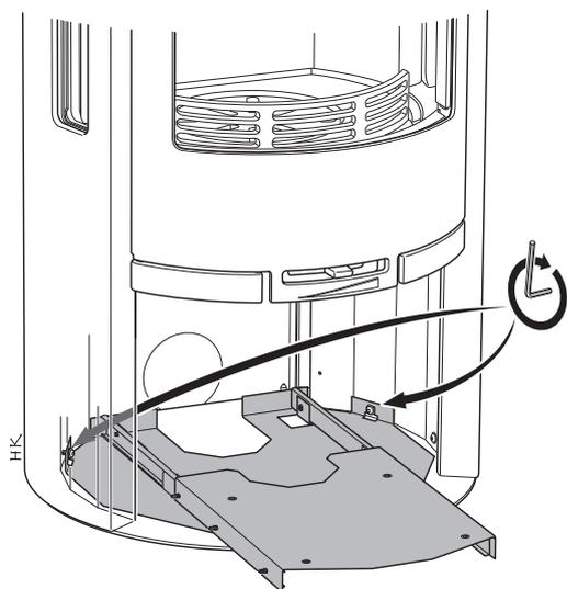
Halten Sie die Auszugseinheit über die hinteren Inbusschrauben. Schrauben Sie die Einheit fest.
