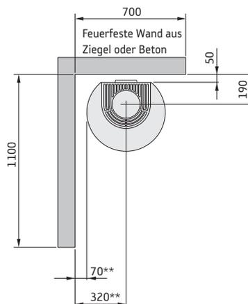
\* Wenn der Kaminofen auf einem Brandschutzbereich z.B. aus Glas (Zubehör) aufgestellt wird, ändert sich die Höhe vom Boden um die Stärke des Brandschutzbereichs. Dies gilt ebenfalls für freiliegende Brandschutzbereiche aus Glas (Zubehör).
