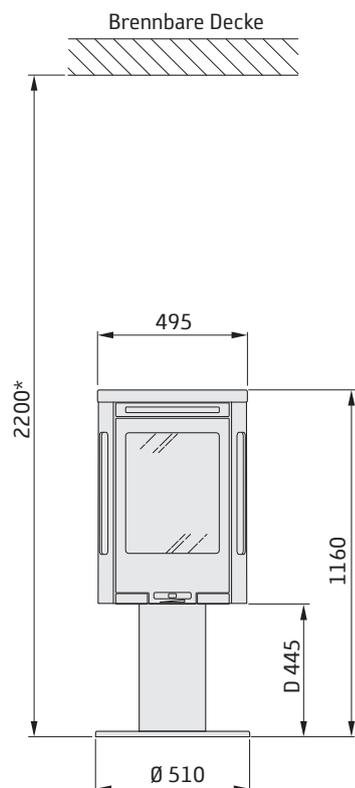
BEI DER INSTALLATION EINES DREHTELLERS (SONDERZUBEHÖR) gelten die unten aufgeführten Installationsabstände nicht. Siehe separate Installationsanleitung für den Drehteller.
