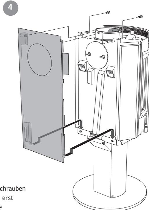
Ziehen Sie die Schrauben am Rückenblech erst an, nachdem alle Seitenverkleidungen angebracht wurden.
