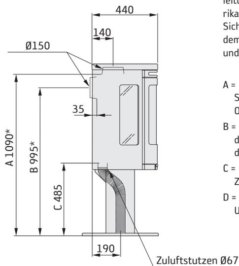
Der Mindestabstand zwischen Kaminofenöffnung und einem brennbaren Gebäudeteil oder Einrichtungsgegenständen beträgt 1 m.
