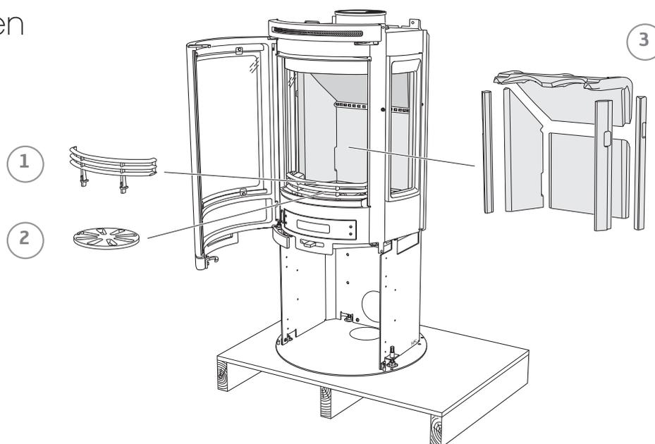
So demontieren Sie die Brennauskleidung (Vermiculit)
