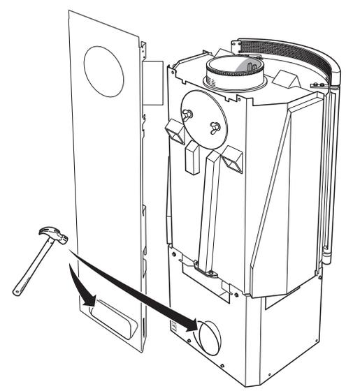
In Rückenblech und Bodenplatte befinden sich Sollbruchstellen, die zwecks Rohrdurchführung oder für eine Luftzufuhr geöffnet werden, wenn der Kaminofen mit einer unteren Tür und bzw. oder einem Ventilator (Zubehör) ausgerüstet ist.
