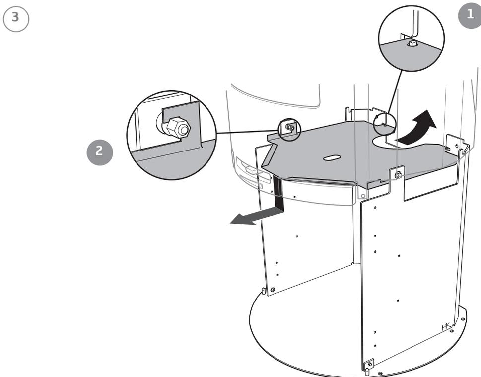
So demontieren Sie die Brennauskleidung (Vermiculit)
