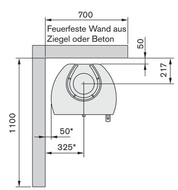
\* Um Verfärbungen an einer gestrichenen Brandmauer zu vermeiden, empfehlen wir denselben seitlichen Abstand wie zu einer brennbaren Wand.
