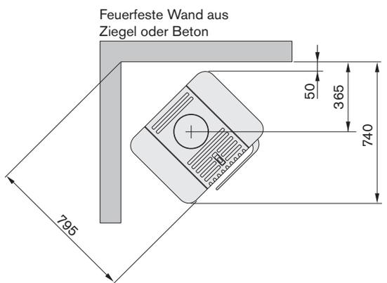
\* Um Verfärbungen an einer gestrichenen Brandmauer zu vermeiden, empfehlen wir denselben seitlichen Abstand wie zu einer brennbaren Wand.
