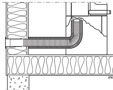
Bei dieser Anschlussart wird zuerst der Sichtschutz entfernt, der sich am Lufteinlass des Rückenblechs befindet.
