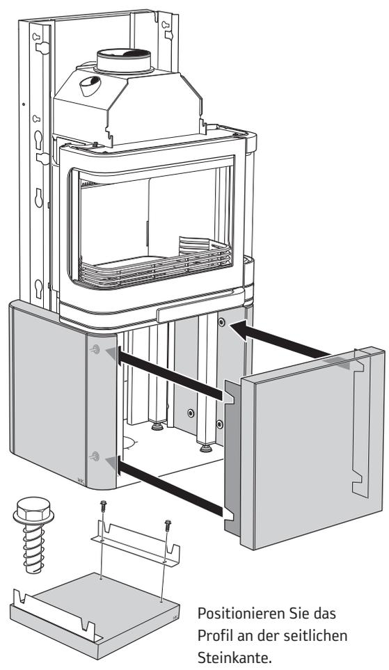
Positionieren Sie das Profil an der seitlichen Steinkante.
