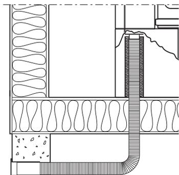
Bei einem Anschluss durch den Boden wird zuerst die Sollbruchstelle im Ausrichtblech und im eventuell vorhandenen Brandschutzbereich entfernt.
