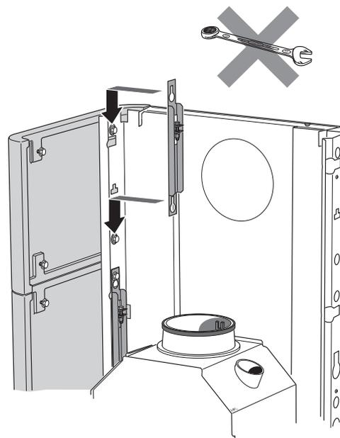
Hängen Sie den Haken in das dahinterliegende Profil ein und ziehen Sie die Schraube bis zum Anschlag an, damit die Seitenplatten nicht nach vorn fallen.
