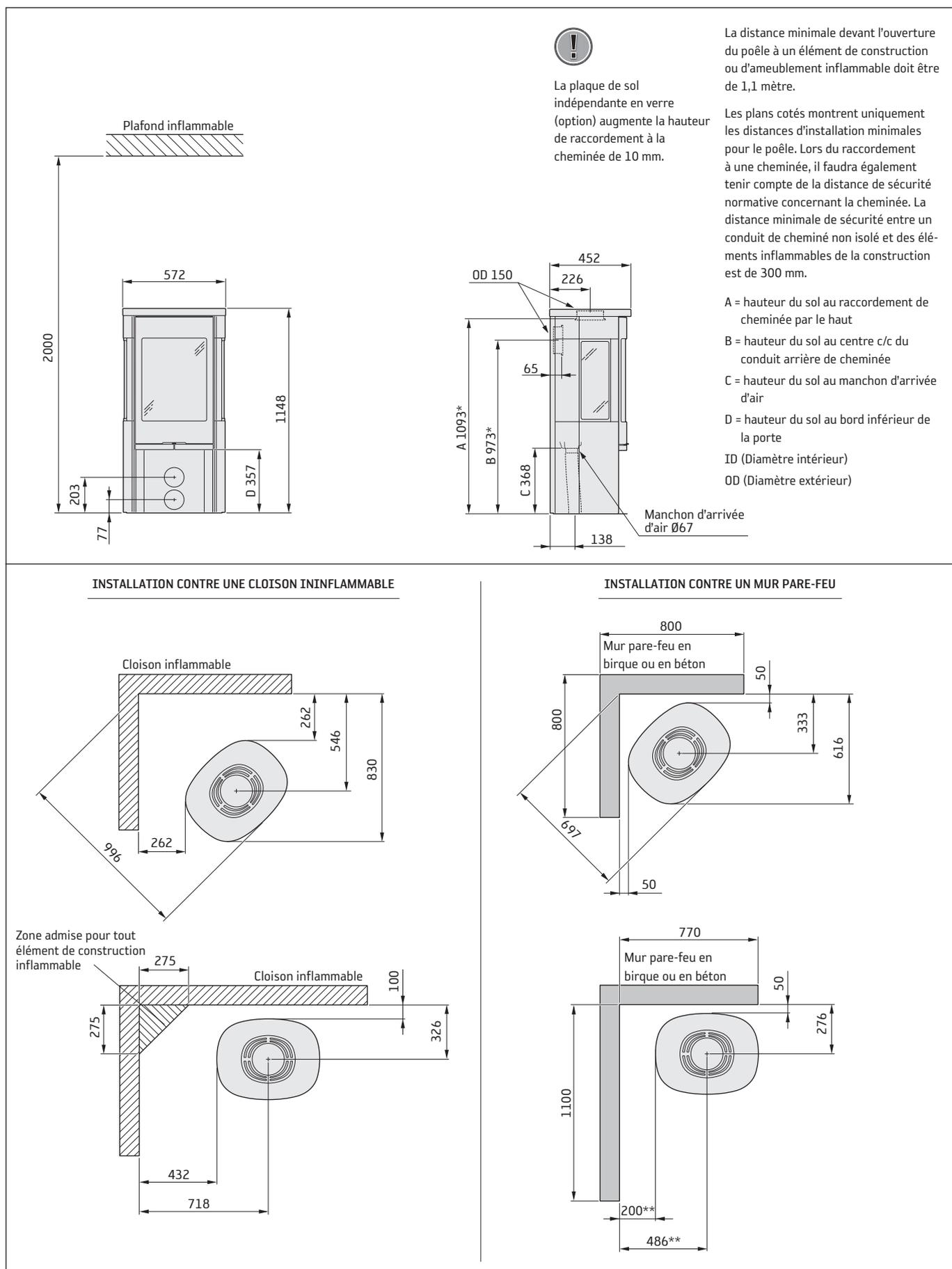
\* Si le poêle est placé sur une plaque de sol en verre par exemple (en option), la hauteur à partir du sol est modifiée d'une valeur correspondant à l'épaisseur de la plaque de sol (10 mm pour une plaque de sol indépendante en verre).
