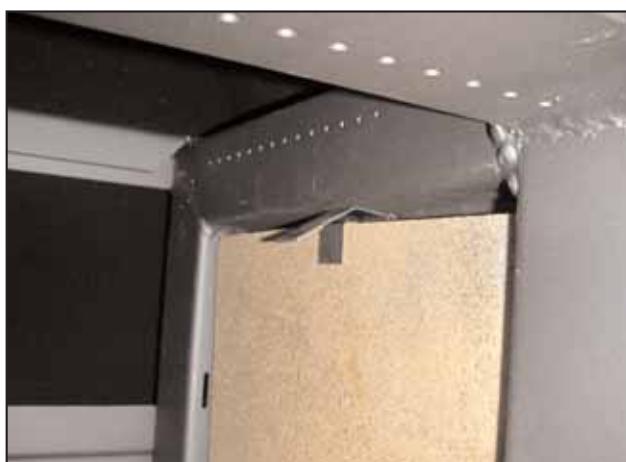
Fäst hållarna på vermiculiteplattorna och montera plattorna på sidorna. Var noga med placeringen av plattorna så att hålen till förbränningsluften ej blockeras, plattorna skall skjutas framåt mot luckan så långt det går.
