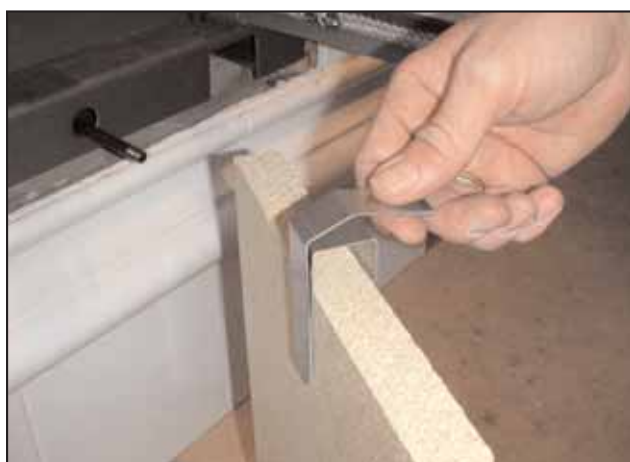
Fäst hållarna på vermiculiteplattorna och montera plattorna på sidorna. Var noga med placeringen av plattorna så att hålen till förbränningsluften ej blockeras, plattorna skall skjutas framåt mot luckan så långt det går.
