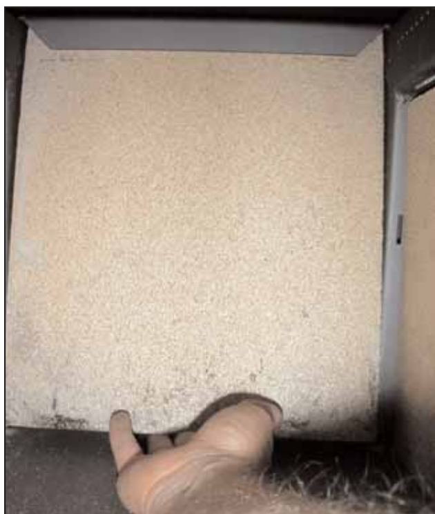
Fäst hållarna på vermiculiteplattorna och montera plattorna på sidorna. Var noga med placeringen av plattorna så att hålen till förbränningsluften ej blockeras, plattorna skall skjutas framåt mot luckan så långt det går.
