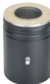
SPJELDMODUL Røygasspjeld for å hindre kaldras. Yttermål: Ø 280 mm Byggelengde: 300 mm
