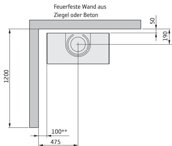
\* Wenn der Kaminofen auf einem Brandschutzbereich z.B. aus Glas (Zubehör) aufgestellt wird, ändert sich die Höhe vom Boden um die Stärke des Brandschutzbereichs. Ein freiliegender Brandschutzbereich aus Glas macht 10 mm aus.
