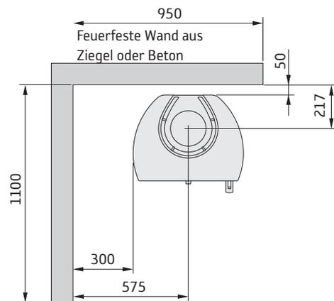
\* Um Verfärbungen an einer gestrichenen Brandmauer zu vermeiden, empfehlen wir denselben seitlichen Abstand wie zu einer brennbaren Wand.
