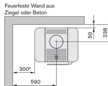
\* Um Verfärbungen an einer gestrichenen Brandmauer zu vermeiden, empfehlen wir denselben seitlichen Abstand wie zu einer brennbaren Wand.
