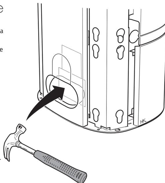
Il collegamento alla presa d'aria esterna può essere fatto attraverso la piastra di protezione del pavimento o a due altezze diverse, attraverso le piastre doppie sul retro della stufa. Rompere il tappo con un martello.
