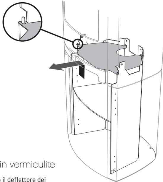
Come rimuovere il rivestimento del focolare in vermiculite
