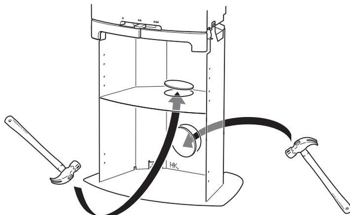
Sul retro e sulla piastra di appoggio della stufa sono presenti dei tappi da rimuovere per il passaggio dei tubi.
