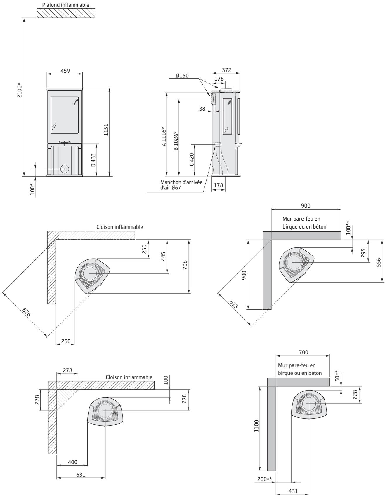
\* Si le poêle est placé sur une plaque de sol en verre par exemple (option), la hauteur à partir du sol est modifiée d'une valeur correspondant à l'épaisseur de la plaque de sol. Valable aussi pour la plaque en verre séparée du poêle (option).
