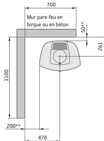
\* Si le poêle est placé sur une plaque de sol en verre par exemple (option), la hauteur à partir du sol est modifiée d'une valeur correspondant à l'épaisseur de la plaque de sol. Valable aussi pour la plaque en verre séparée du poêle (option).
