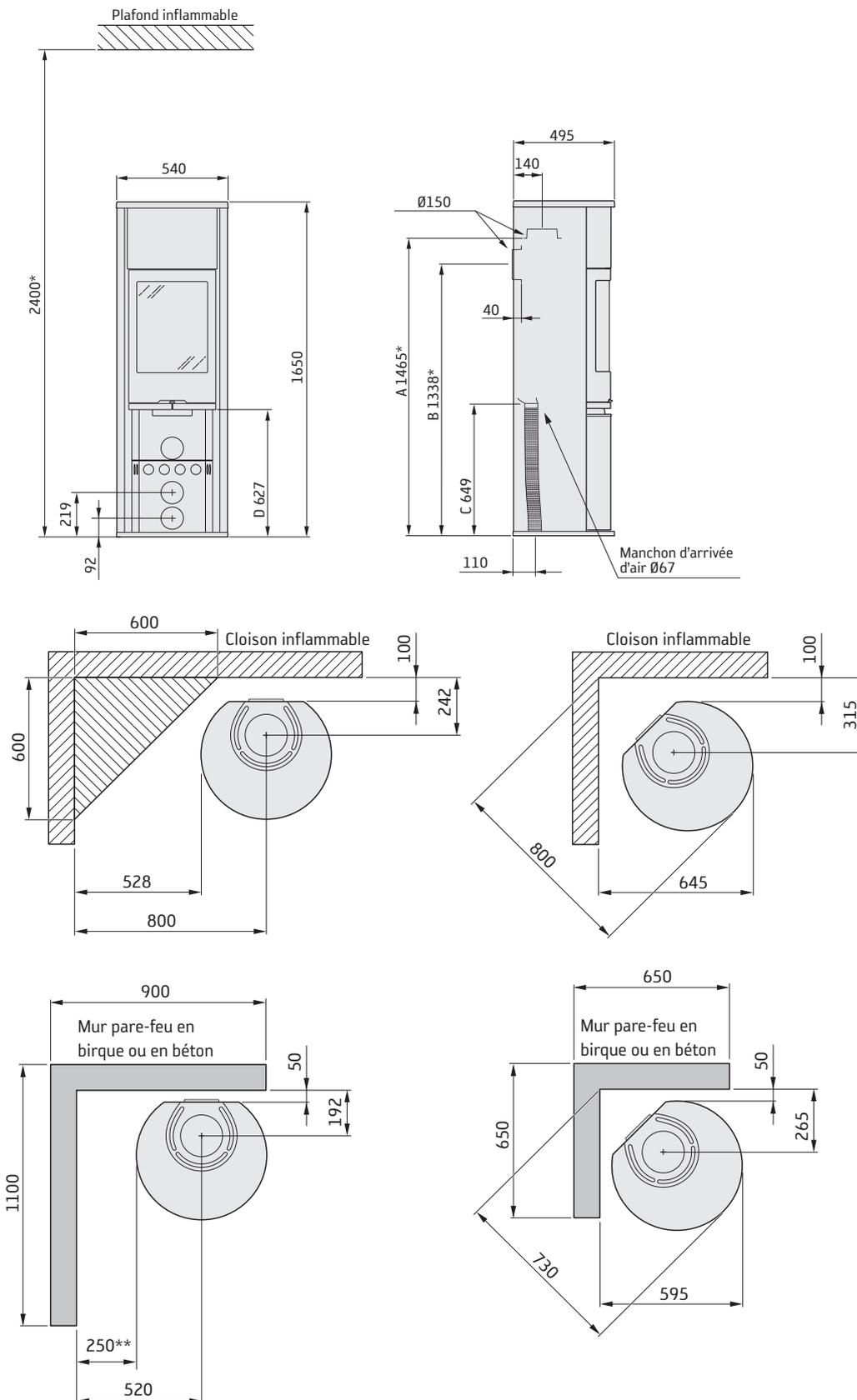
\* Si le poêle est placé sur une plaque de sol en verre par exemple (en option), la hauteur à partir du sol est modifiée d'une valeur correspondant à l'épaisseur de la plaque de sol (10 mm pour une plaque de sol indépendante en verre).
