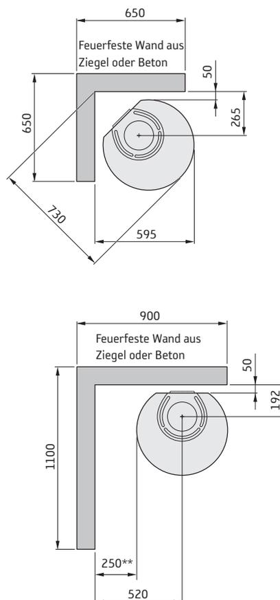
\* Wenn der Kaminofen auf einem Brandschutzbereich z.B. aus Glas (Zubehör) aufgestellt wird, ändert sich die Höhe vom Boden um die Stärke des Brandschutzbereichs. Ein freiliegender Brandschutzbereich aus Glas macht 10 mm aus.
