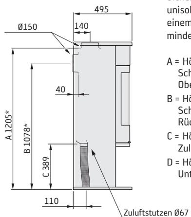
Der Mindestabstand zwischen Kaminofenöffnung und einem brennbaren Gebäudeteil oder Einrichtungsgegenständen beträgt 1,2 m.
