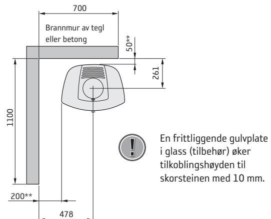
\* Hvis ovnen plasseres på en gulvplate av for eksempel glass (tilbehør), påvirkes høyden fra gulvet tilsvarende gulvplatenes tykkelse. Gjelder også frittliggende gulvplate av glass (tilbehør).
