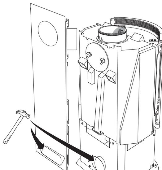
I bakplaten og gulvplaten finnes det brytelokk som fjernes for gjennomføring av rør eller for lufttilførsel hvis ovnen utstyres med en nedre dør og/eller vifte (tilbehør).
