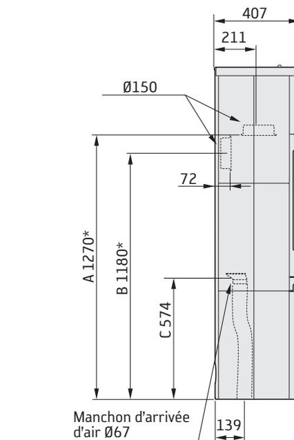
La distance minimale devant l'ouverture du poêle à un élément de construction ou d'ameublement inflammable doit être de 1 mètre.
