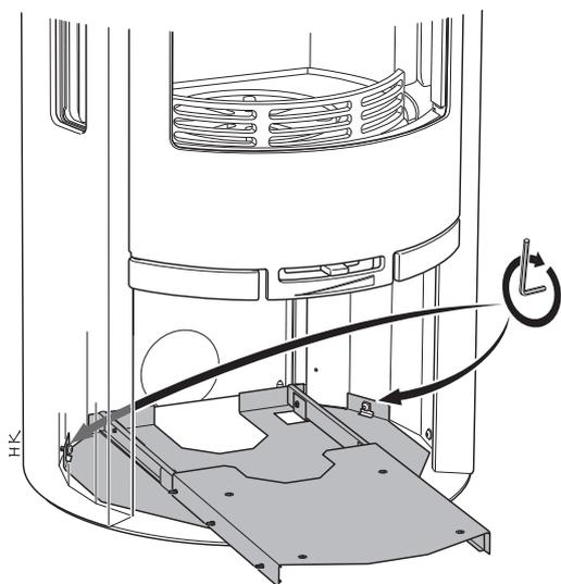
Accrochez l'élément de guidage aux vis hexagonales arrière. Serrez les vis de l'élément de guidage.
