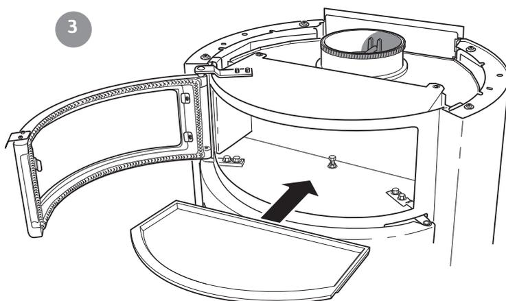
Placez ensuite la plaque de cuisson dans le four. Réglez si besoin la hauteur de la plaque de cuisson avec la vis de réglage située sur le fond du four.
