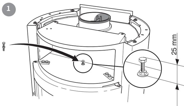
Changez la vis de réglage prémontée du compartiment de convection contre la vis de réglage fournie. Placez la plaque chauffante dans le compartiment de convection. Utilisez la vis de réglage du bord arrière pour le montage horizontal. Sur le côté du compartiment se trouve une petite fente qui sert à monter la plaque de couverture arrière.
