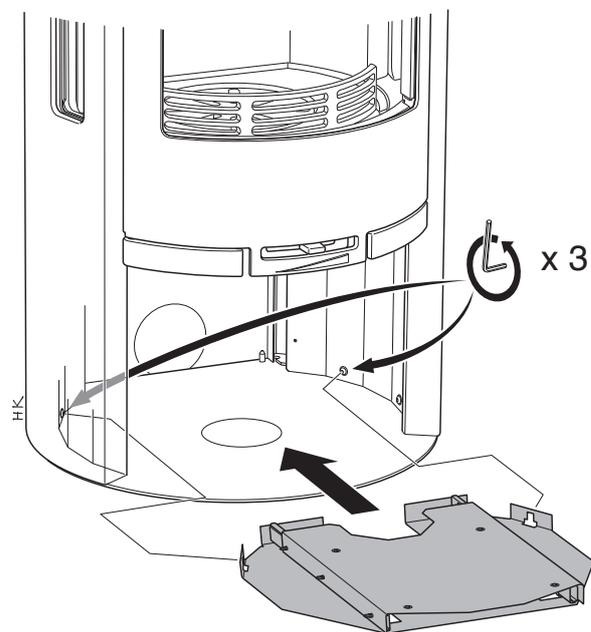
Desserrez la vis hexagonale arrière de trois tours. Placez l'élément de guidage sur la plaque de pied.
