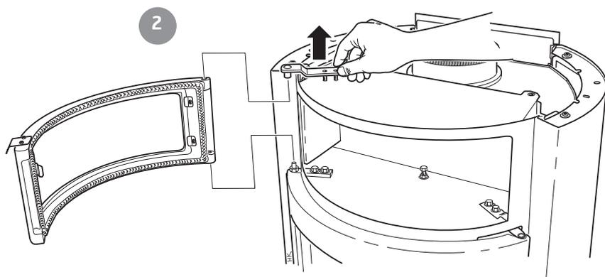
Placez la porte du four de cuisson sur le goujon. Accrochez le gond supérieur et serrez l'une des vis légèrement. Fermez la porte du four et réglez son horizontalité. Ouvrez avec précaution la porte du four et serrez les deux vis.
