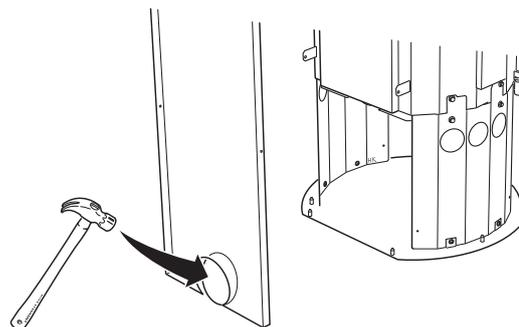
La plaque arrière et la plaque de sol comportent des caches à découper pour le passage du conduit ou pour l'alimentation d'air, si le poêle est équipé d'un cendrier, d'une porte inférieure et/ou d'un ventilateur (option).
