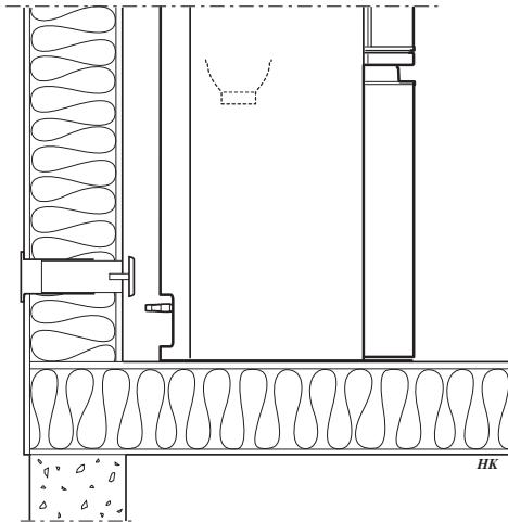
**SE** Installation typ 1, ej lämplig i hus med undertryck.**EN** Installation type 1, not suitable in houses with negative pressure.**DE** Installationstyp 1, nicht geeignet in Häusern mit Unterdruck.**FR** Type d'installation 1, ne convient pas dans les maisons à pression négative (dépression).
