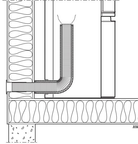
**NL** Installatie type 1, niet geschikt in een woning met onderdruk.**NO** Installasjonstype 1, ikke egnet i hus med undertrykk.**DK** Installation type 1, ikke velegnet til huse med undertryk.**FI** Typpi 1 asennus, ei sovellu taloihin, joissa on alipaine.
